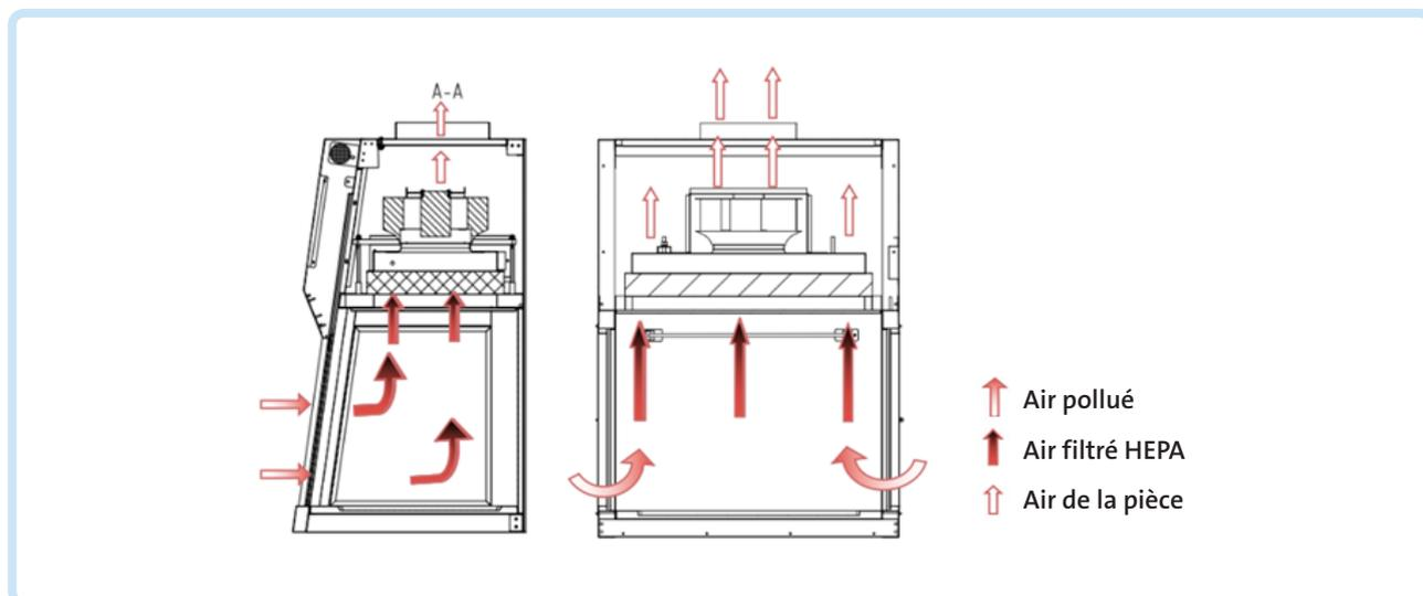
L'armoire à flux laminaire NP-800 UV crée un environnement d'air local très propre grâce à un flux d'air vertical. Elle est largement utilisée dans le processus de préparation de médicaments dans les officines afin de protéger l'utilisateur contre l'inhalation de substances dangereuses. Elle est recommandée lors du mélange et du remplissage des gélules avec ces substances. Elle est très utile pour augmenter le rendement, la précision, la stabilité et la fiabilité des produits.
